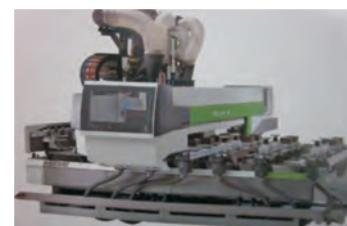
五轴加工中心，一次成型加工中心设备机器
